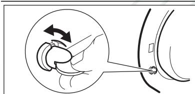
Если данное устройство включено, то закрыть дверцу невозможно. Это позволяет избежать опасности запирания дверцы в случае попадания в барабан детей или домашних животных. Чтобы включить данное устройство, поверните переключатель по часовой стрелке так, чтобы канавка оказалась в горизонтальном положении. Чтобы выключить данное устройство, поверните переключатель против часовой стрелки так, чтобы канавка оказалась в вертикальном положении.
